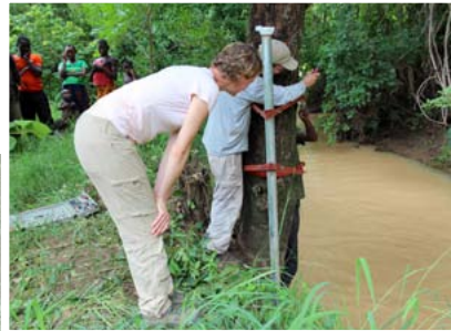
Einrichtung einer Messstation zur Erfassung des Wasserspiegels in Burkina Faso. Fotos: Gero Steup
