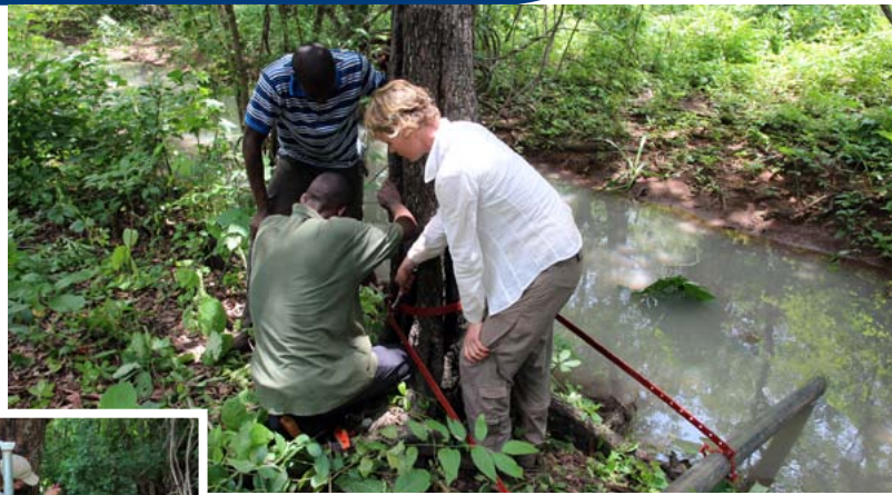
Einrichtung einer Messstation zur Erfassung des Wasserspiegels in Burkina Faso. Fotos: Gero Steup
